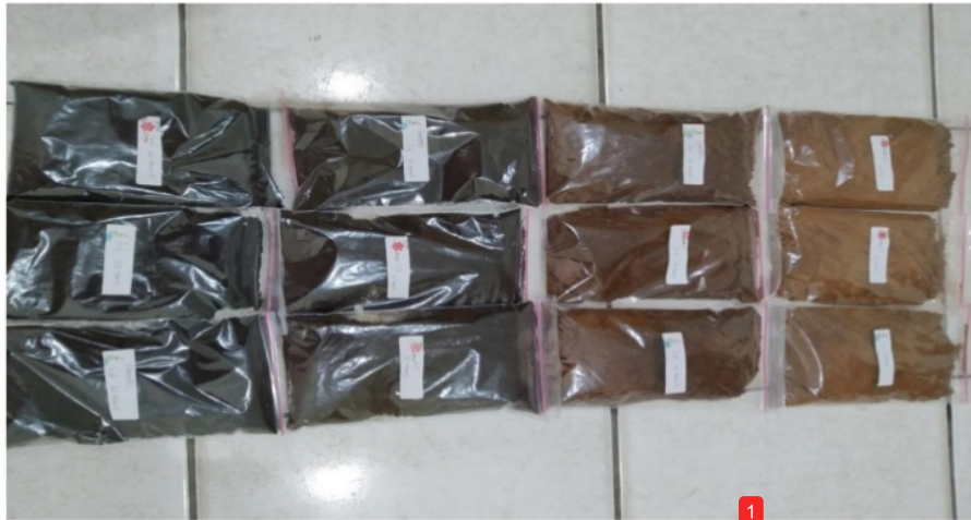
Gambar 2. Tingkat kehitaman bubuk kopi hasil penyangraian dengan waktu 5, 10, 15 dan 20 menit pada suhu 240°C
